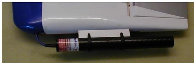
Comme il y a un dépôt de suie sur les évaporateurs lors du fonctionnement, le réglage des restrictions doit être ajusté de temps en temps. L'ajustement arrive à sa fin lorsque les restrictions sont entièrement ouvertes et que le débit de fumée est faible. Cela arrive après avoir fait évaporer un litre de Redoil. Alors les tubes à fumée doivent être nettoyés (voir notice de nettoyage). Nous conseillons un nettoyage tous les 10 vols environ.
